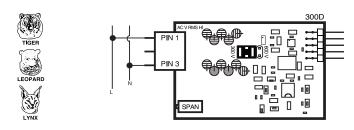
IA07: AC Volts True RMS, 200mV/2V/20V AC
