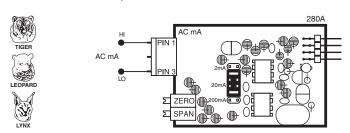
IA04: AC AC Amps Scaled RMS, 1 Amp AC IA05: AC AC Amps Scaled RMS, 5 Amp AC
