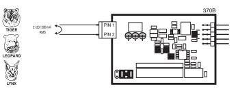
IAO9: AC Amps True RMS, 1 Amp AC IA11: AC Amps True RMS, 5 Amp AC
